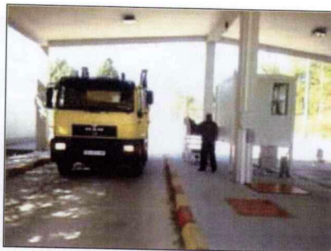
Слика бр.1 - Камionsка вага со командна кабина на влезот на депонијата Дрисла
